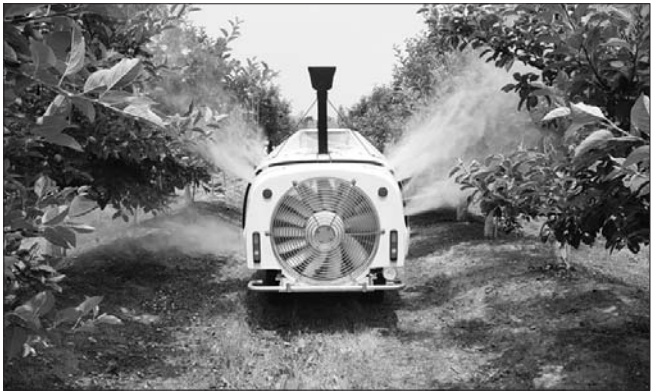
농촌진흥청은 과수원 안에서 스스로 이동하며 나무의 유무와 모양을 신속·정확하게 측정해 농약을 살포하는 스마트 로봇 방제기를 개발했다.
